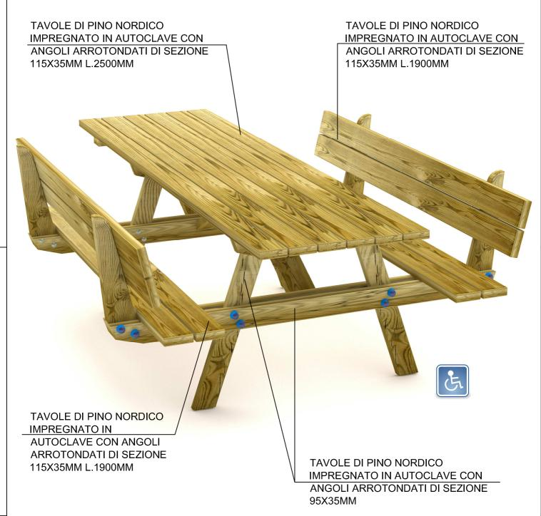
TUTTI GLI ELEMENTI DI FISSAGGIO, VITI, DADI, RONDELLE ECC. SONO IN ACCIAIO INOSSIDABILE E PROTETTI DA GHIERE E TAPPI IN POLIETILENE
