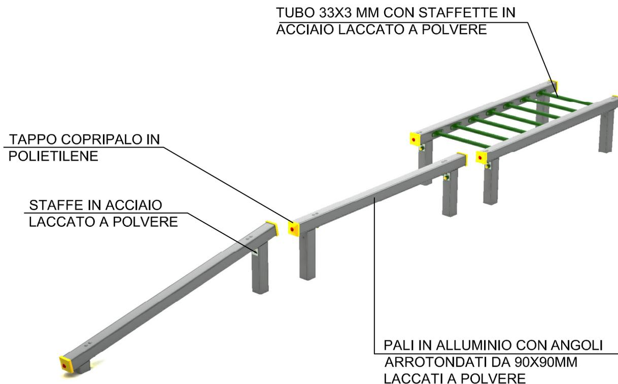
TUTTI GLI ELEMENTI DI FISSAGGIO, VITI, DADI, RONDELLE ECC. SONO IN ACCIAIO ZINCATO E PROTETTI DA GHIERE E TAPPI IN POLIETILENE
