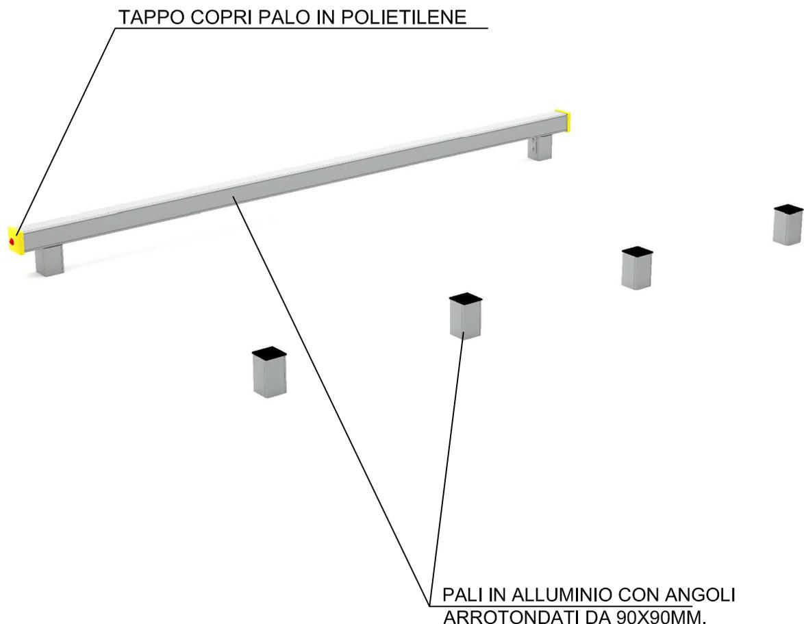
TUTTI GLI ELEMENTI DI FISSAGGIO, VITI, DADI, RONDELLE ECC. SONO IN ACCIAIO INOSSIDABILE E PROTETTI DA GHIERE E TAPPI IN POLIETILENE
