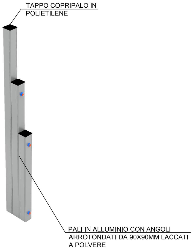
TUTTI GLI ELEMENTI DI FISSAGGIO, VITI, DADI, RONDELLE ECC. SONO IN ACCIAIO ZINCATO E PROTETTI DA GHIERE E TAPPI IN POLIETILENE.
