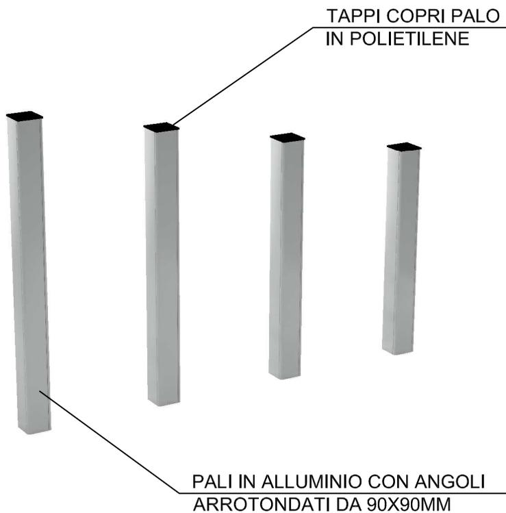
TUTTI GLI ELEMENTI DI FISSAGGIO, VITI, DADI, RONDELLE ECC. SONO IN ACCIAIO INOSSIDABILE E PROTETTI DA GHIERE E TAPPI IN POLIETILENE.
