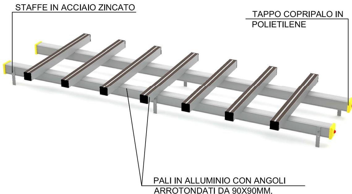
TUTTI GLI ELEMENTI DI FISSAGGIO, VITI, DADI, RONDELLE ECC. SONO IN ACCIAIO INOSSIDABILE E PROTETTI DA GHIERE E TAPPI IN POLIETILENE
