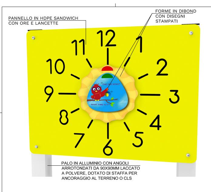
TUTTI GLI ELEMENTI DI FISSAGGIO, VITI, DADI, RONDELLE ECC. SONO IN ACCIAIO ZINCATO E PROTETTI DA GHIERE E TAPPI IN POLIETILENE
